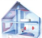
Abb. 1: Die Systemkomponenten einer Wärmeübergabe bestehen aus Systemrohr mit Befestigung, optional mit Systemleitung, Non-Kältemittelrohr einschließlich Regelventiltrieb, Raumthermostate und Bodenheizkörper, Quelle: Fachbereich Flächenheizung/-kühlung im BDH
