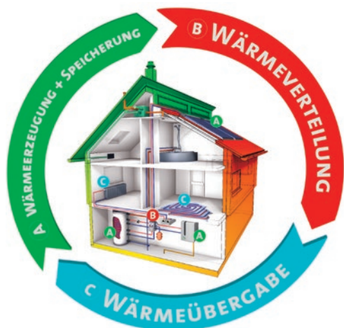
Bild 02: Komponenten eines Heizsystems im Einfamilienhaus.
