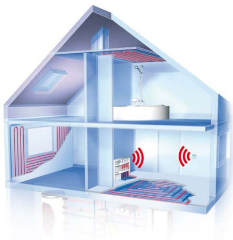
Abb. 1: Die Systemkomponenten einer Wärmeübergabe bestehen aus Systemrohr inkl. Befestigung, (optional mit Systemplatte), Heiz-/Kühlkreisverteiler einschließlich Regelungstechnik, Raumthermostate und Bedieneinheiten, Quelle: Fachbereich Flächenheizung/-kühlung im BDH
