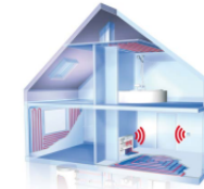
Abb. 1: Die Systemkomponenten einer Wärmeübergabe bestehen aus Systemrohr (inkl. Befestigung, optional mit Systempletzt), Heiz-/Kühlkreisverteiler einschließlich Reglungstechnik, Raumthermostate und Bedieneinheiten, Quelle: Fachbereich Flächenheizung/-kühlung im BDH
