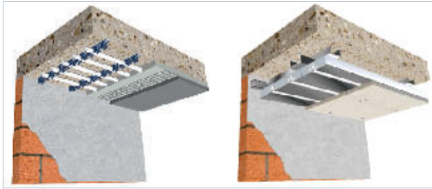
Bild 7 Deckenheizung/-kühlung in verschiedenen Ausführungssystemen
